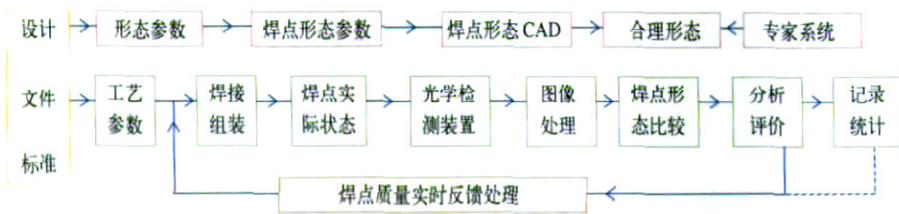
图3 采用焊点形态图识别和专家系统分析的智能化 AOI 系统原理图
